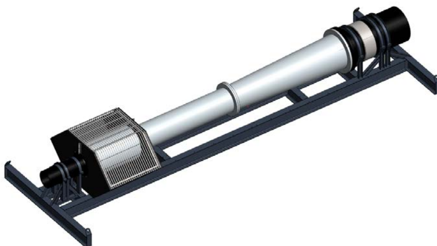
Kuva 4-8. Ejektori ja välppä.
