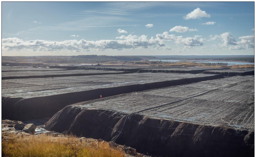
Kuva 6-2. Ilmakuva ja valokuva primääribioliuotusalueesta (kts. Kuva 2-1 alue B). Mittasuhteita voi hahmottaa valokuvasta, jossa näkyy ihminen kävelemässä kasan päällä.
