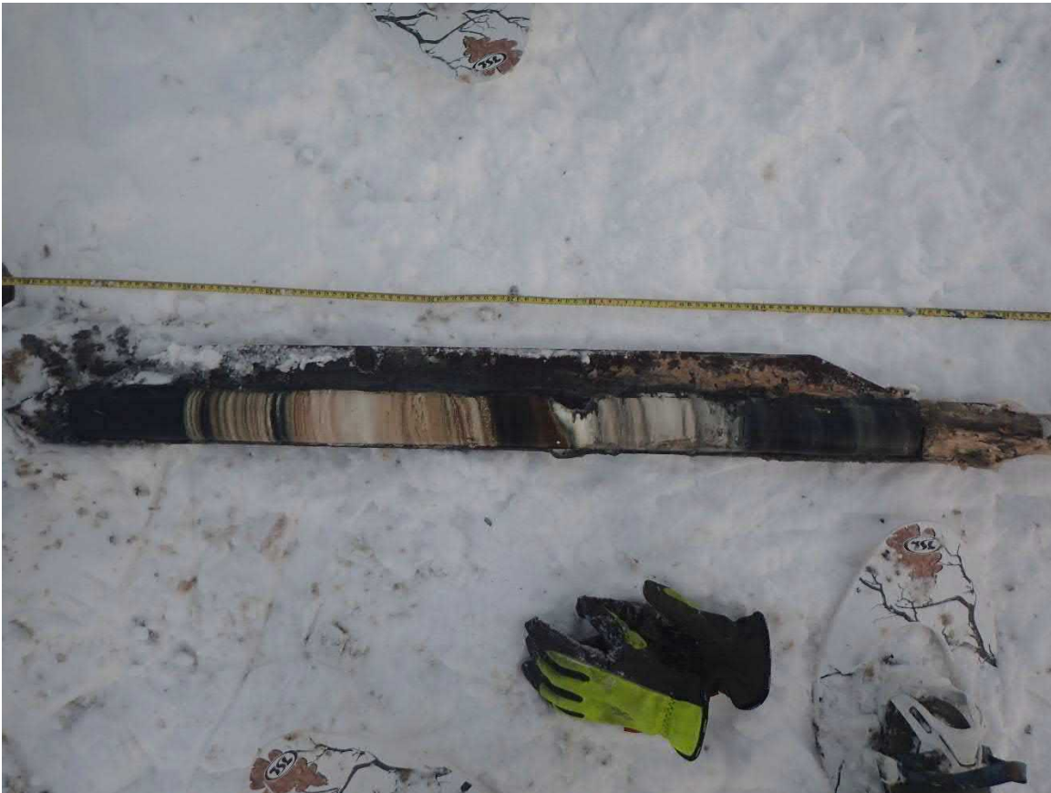
Kuva 15. Haukilampi SP19. Sakkakerrokset vaihtelivat mustan, vaaleanruskean, valkoisen ja sinertävän välillä. Pohjalla turve.
