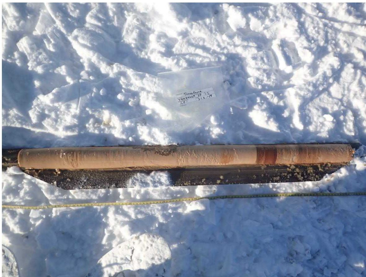
Kuva 3. Kaivoksen Kuusilampi SP25. Pisteessä sakka paikoin vaaleanruskeaa ja vaaleanoranssia. Sakkaa ainakin 5,2 m.
