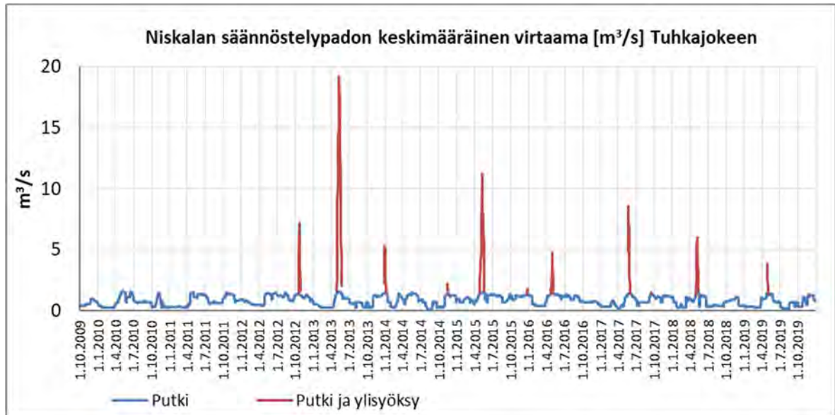
Kuva 5-14. Niskalan padon juoksutusputken virtaama sekä Kolmisopen pinnan korkeuden perusteella laskeutu ylisyöksykynnyksen virtaama ( \text{m}^3/\text{s} ) Tuhkajokeen aikavälillä 5.10.2009-31.12.2019.
