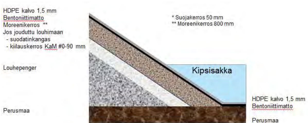
Kuva 4-14. Kipsisakka-altaan 2 (lohkot 3-6) korotusosat sekä uuden kipsisakka-altaan 3 ympäristölupa-hakemuksessa haettu rakenne (tulevat lohkot 7 ja 8). (Pöyry Finland Oy 2018a)
