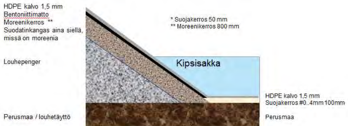
Kuva 4-13. Kipsisakka-allas 1 (lohkot 1-2). (Pöyry Finland Oy 2018a)
