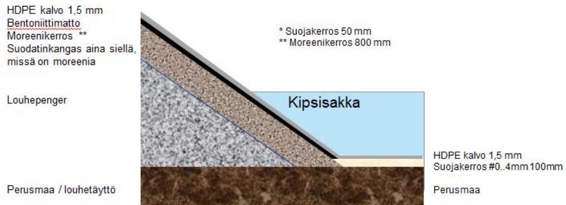
Kuva 3-11. Kipsisakka-allas 1 (lohkot 1-2). (Pöyry Finland Oy 2018)
