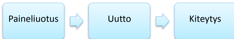
Kuva 3-5. Nikkeli- ja kobolttisulfaattien valmistuksen päävaiheet.
