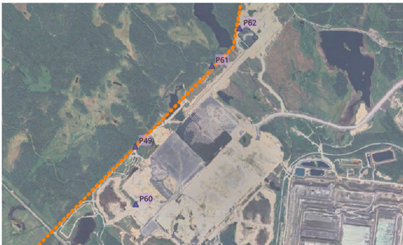
Kuva 3-21. Sekundäärkentän 2 alueen (lohkot 5-8) tarkkailuputket. Kallioputket merkattu kolmiolla ja maaputket ympyrällä.
