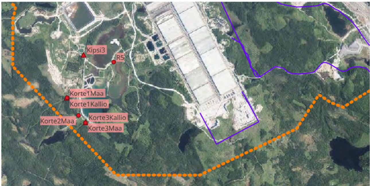
Kuva 3-9. Kortelamman alueen pohjaveden tarkkailuputket. Kallioputket merkattu kolmiolla ja maaputket ympyrällä.
