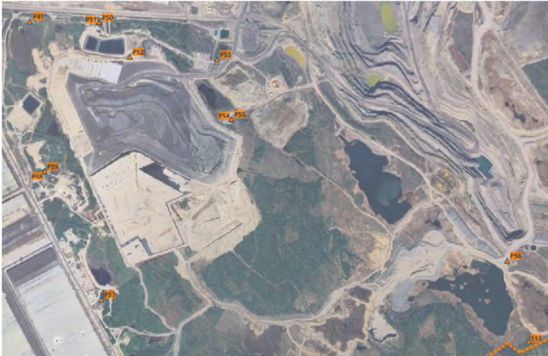
Kuva 3-24. Sivukivialueen KL1 alueen tarkkailuputket. Kallioputket merkattu kolmiolla ja maaputket ympyrällä.
