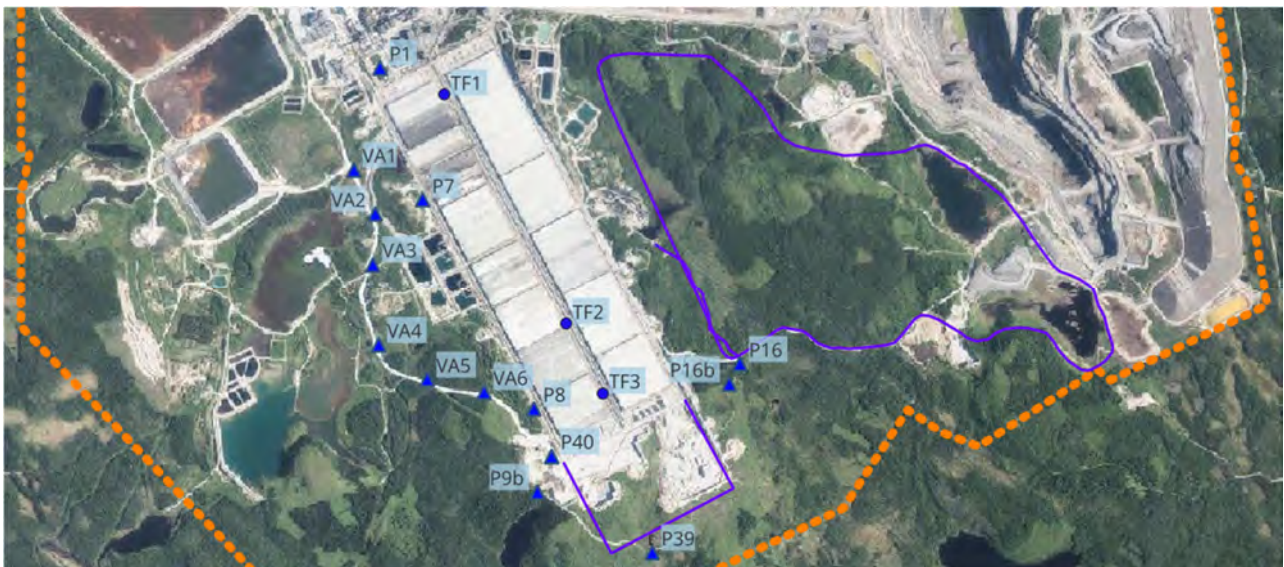
Kuva 3-5. Tehdas- ja primäärilentän alueen tarkkailuputket. Kallioputket merkattu kolmiolla ja maaputket ympyrällä.
