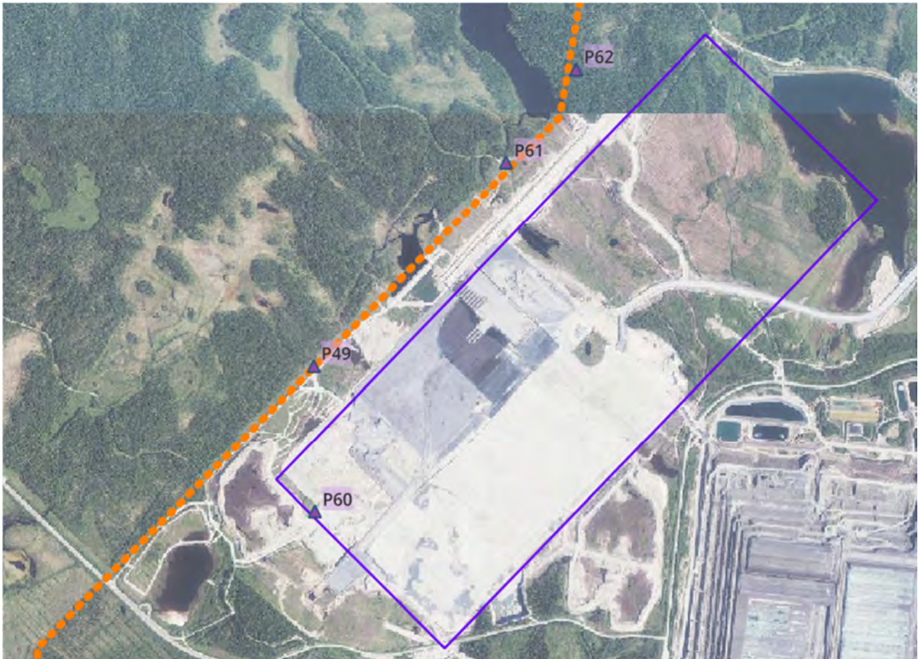
Kuva 3-21. Sekundäärikentän 2 alueen (lohkot 5-8) tarkkailuputket. Kallioputket merkattu kolmiolla ja maaputket ympyrällä.
