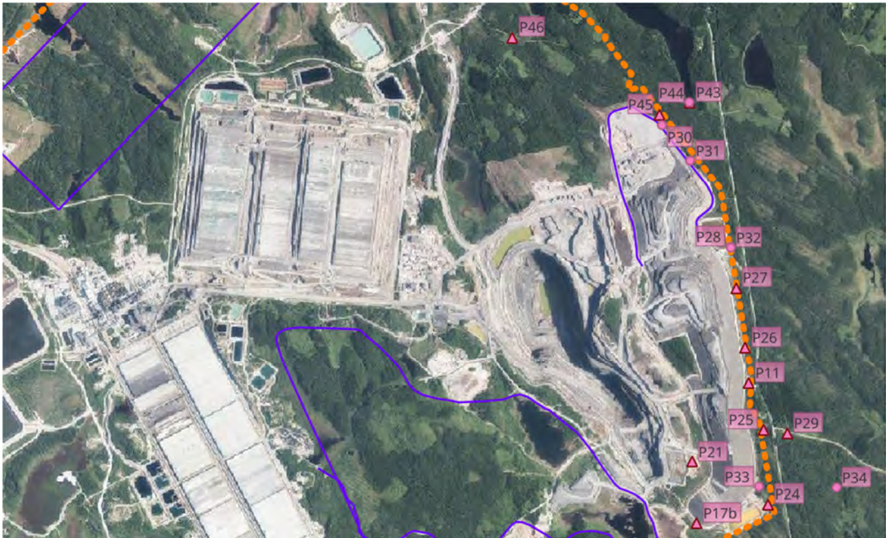
Kuva 3-1. Alueella sijaitsevat pohjaveden tarkkailuputket, Kuusilammen alue. Kallioputket merkattu kolmiolla ja maaputket ympyrällä.
