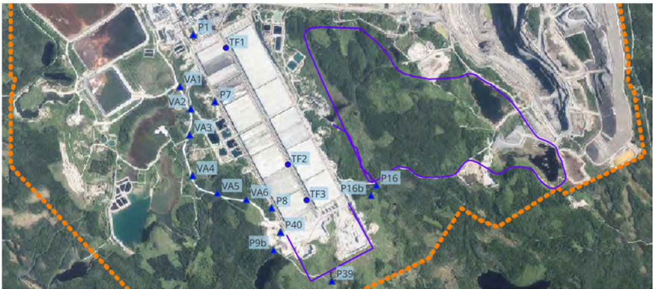
Kuva 3-5. Tehdas- ja primäärkentän alueen tarkkailuputket. Kallioputket merkattu kolmiolla ja maaputket ympyrällä.
