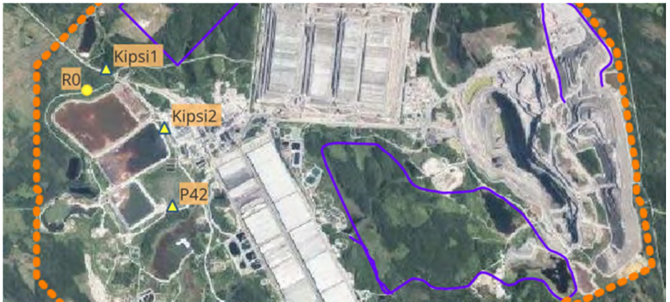
Kuva 3-13. Kipsisakka-altaiden alueen pohjaveden tarkkailuputket. Kallioputket merkattu kolmiolla ja maaputket ympyrällä.
