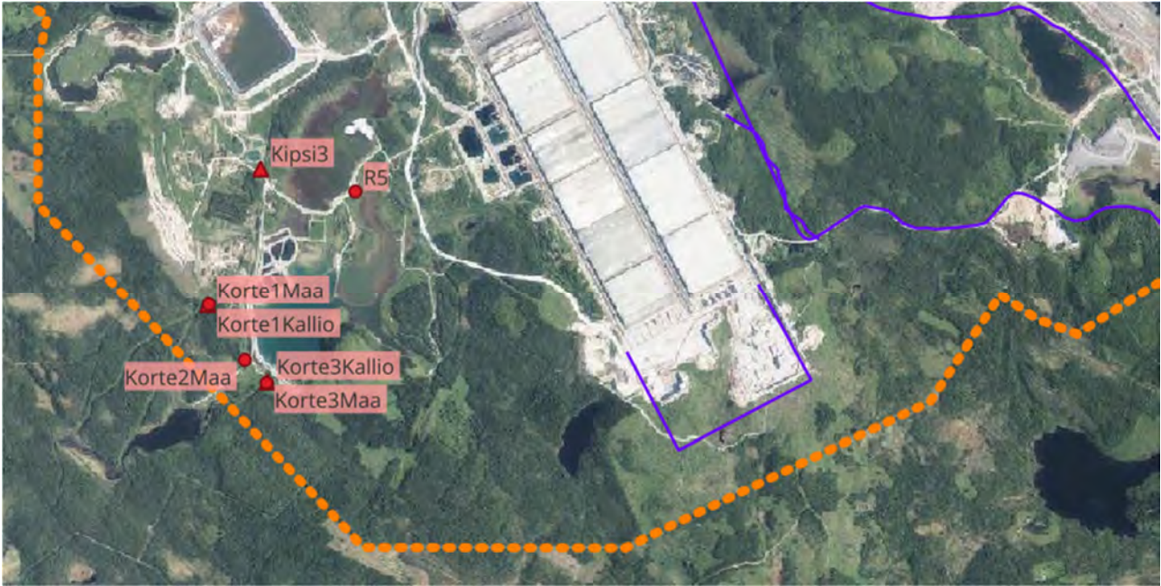
Kuva 3-9. Kortelammen alueen pohjaveden tarkkailuputket. Kallioputket merkattu kolmiolla ja maaputket ympyrällä.
