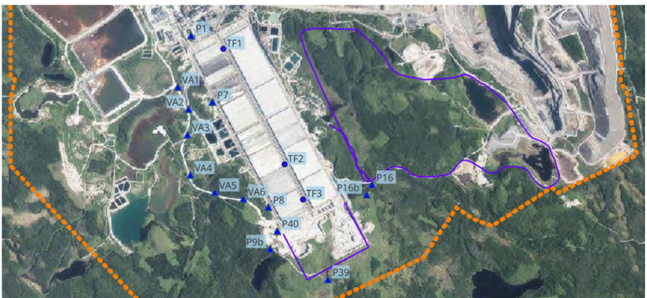
Kuva 3-4. Tehdas- ja primäärilentän alueen tarkkailuputket. Kallioputket merkattu kolmiolla ja maaputket ympyrällä.
