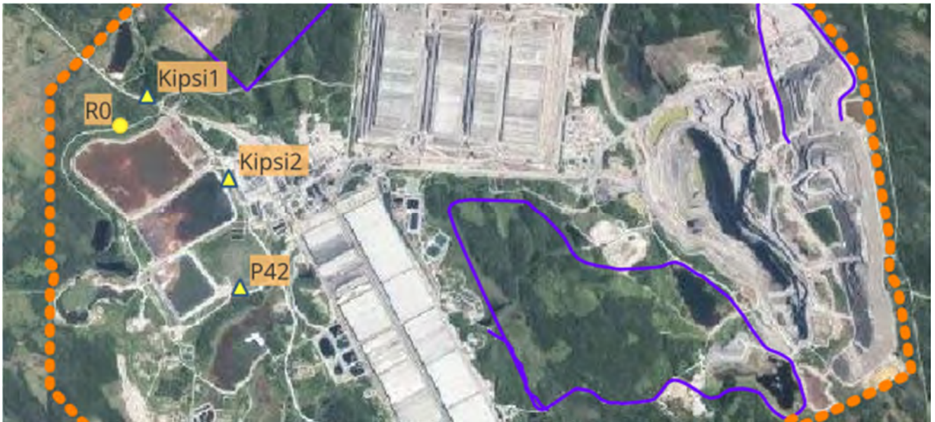
Kuva 3-10. Kipsisakka-altaiden alueen pohjaveden tarkkailuputket. Kallioputket merkattu kolmiolla ja maaputket ympyrällä.
