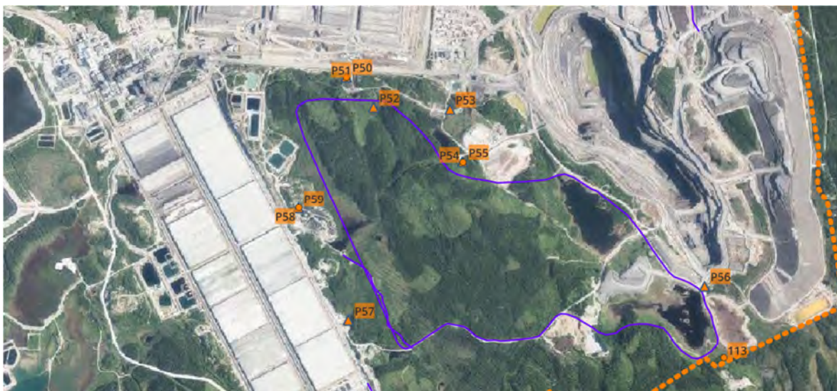
Kuva 3-17. Sivukivialueen KL1 alueen tarkkailuputket. Kallioputket merkattu kolmiolla ja maaputket ympyrällä.
