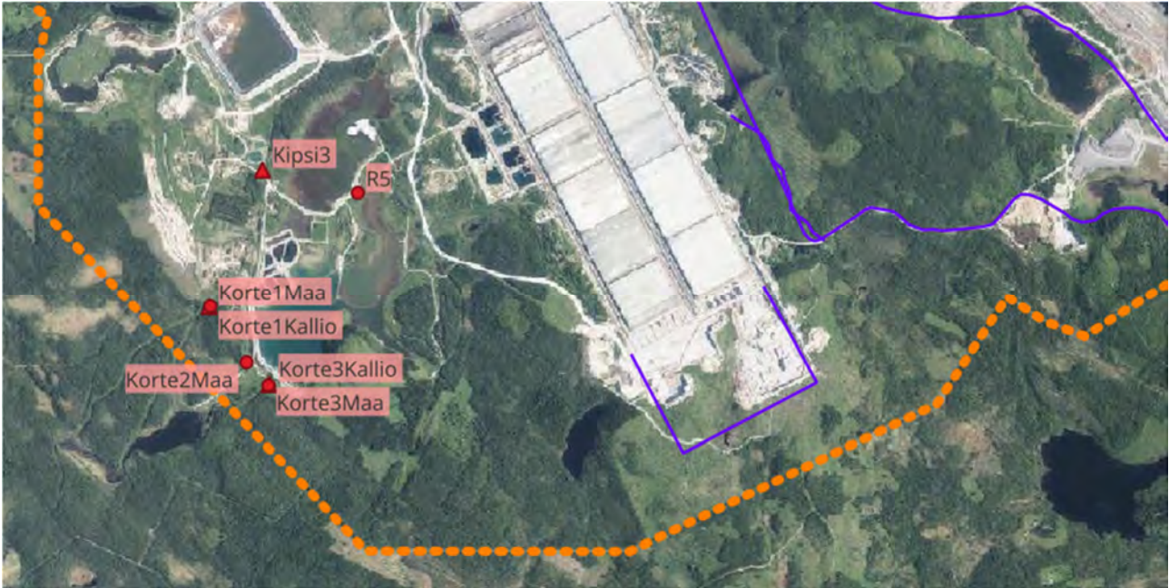
Kuva 3-7. Kortelammen alueen pohjaveden tarkkailuputket. Kallioputket merkattu kolmiolla ja maaputket ympyrällä.
