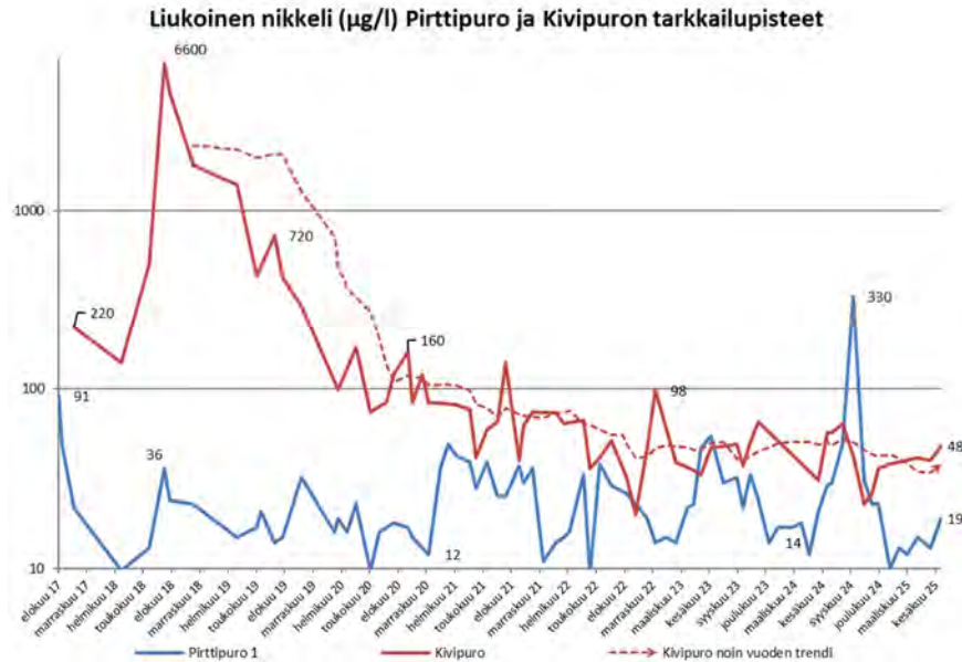
Kuva 3–18. Pirtti- ja Kivipuron sähköjohtavuus sekä liukoisen nikkeli tuloksia elokuusta 2017 alkaen. Huomaa logaritmiset asteikot.
