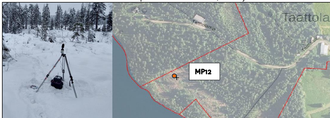
Kuva 2. Meluanturin asennuskuva mittauspisteeltä melulähteelle, sekä sijainti kartalla.
