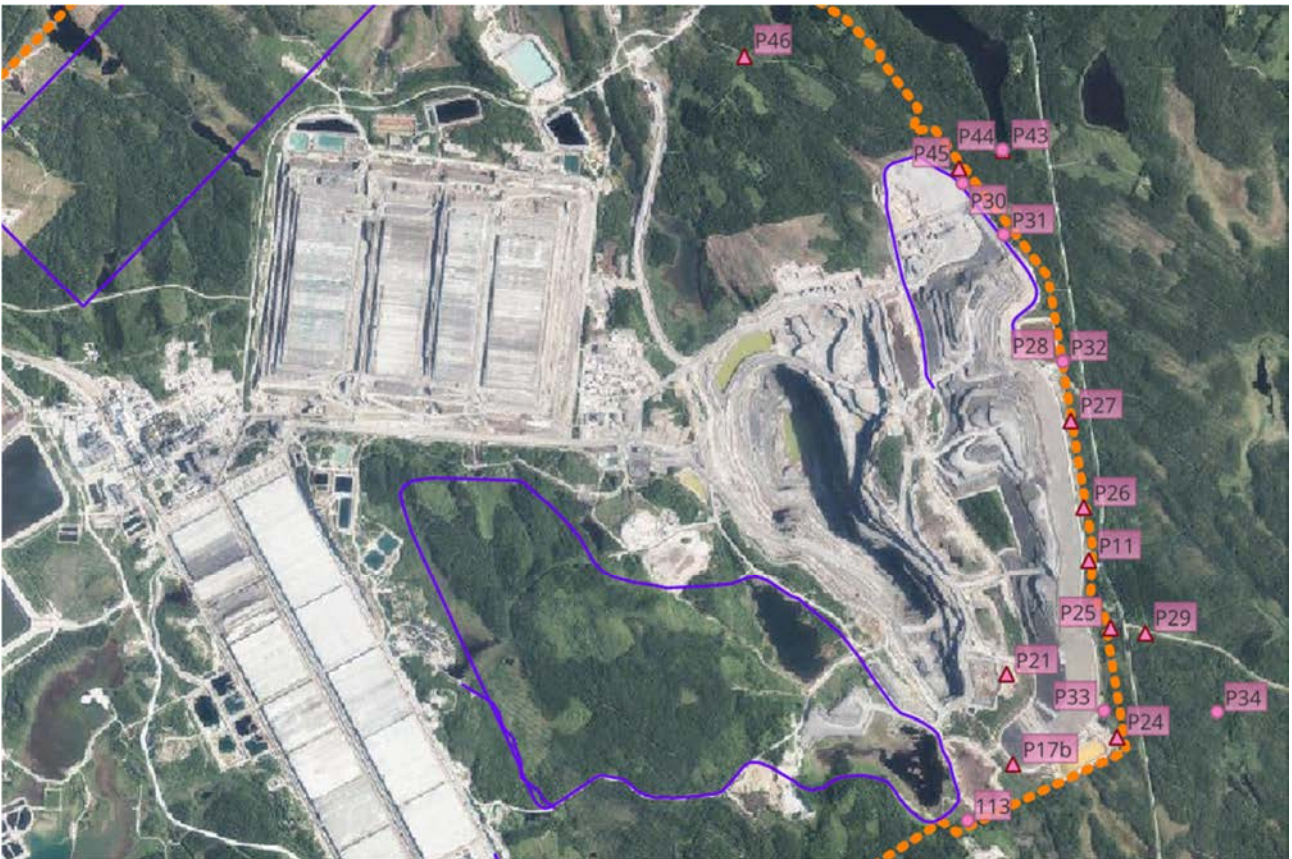
Kuva 3-1. Alueella sijaitsevat pohjaveden tarkkailupisteet, sivukivialue KL2. Kallioputket merkattu kolmiolla ja maaputket ympyrällä.
