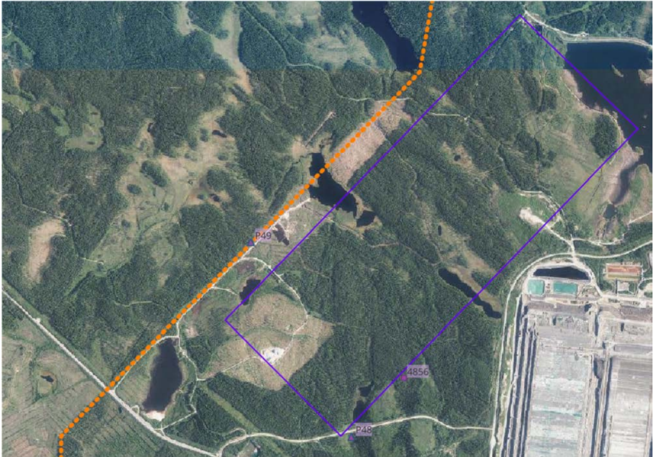
Kuva 3-16. Uuden sekundäärikentän (lohkot 5-8) tarkkailupisteet. Kallioputket merkattu kolmiolla ja maaputket ympyrällä.
