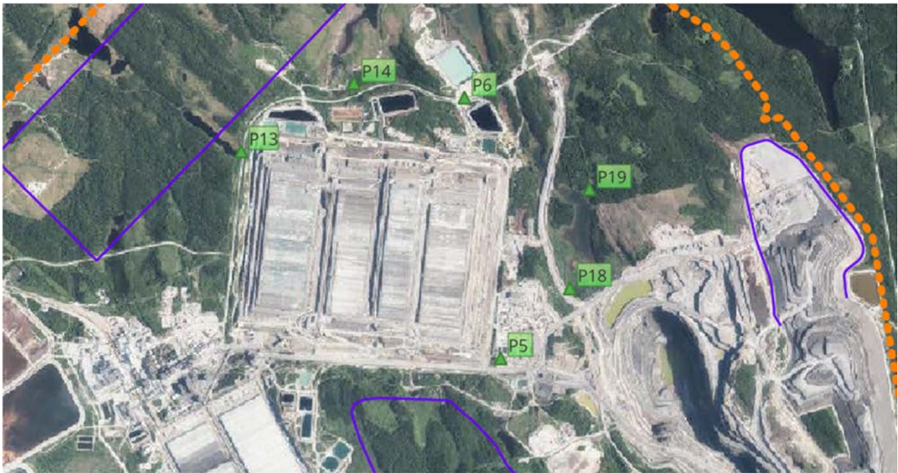
Kuva 3-13. Sekundäärikentän ympäristön pohjaveden tarkkailupisteet. Kallioputket merkattu kolmiolla.
