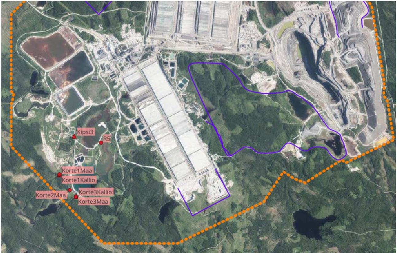
Kuva 3-7. Kortelammen ympäristön pohjaveden tarkkailupisteet. Kallioputket merkattu kolmiolla ja maaputket ympyrällä.
