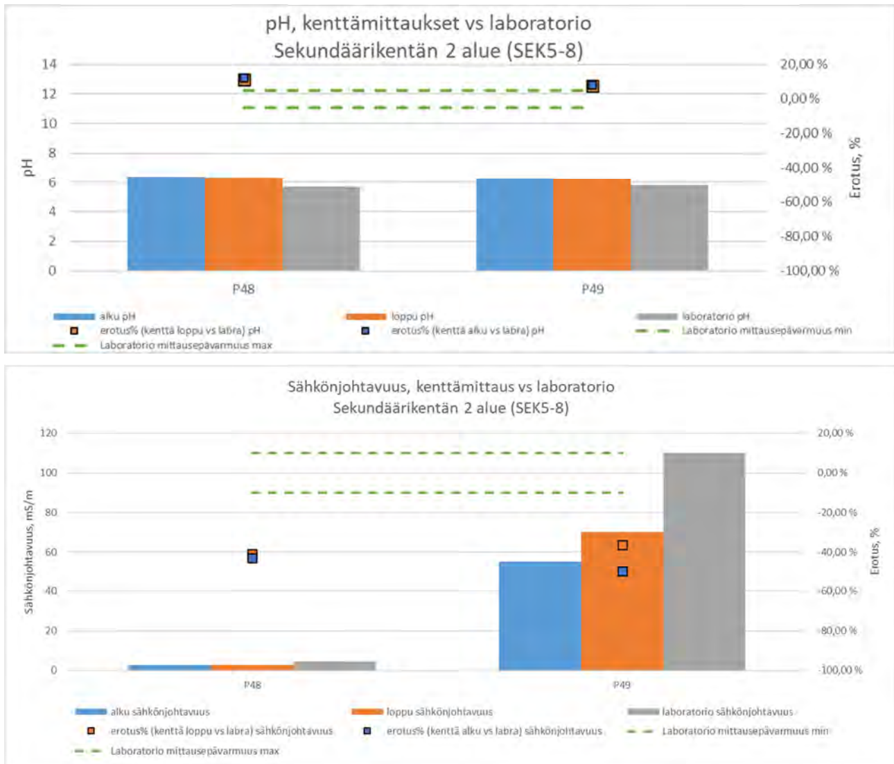
Kuva 3-22. Kenttämittaustulokset näytteenottopumppauksen alussa ja näytteenoton lopussa, sekä vertailu laboriotulokseen. Huomaa kuvaajan kaksi eri muuttujaa pystyakselilla.
