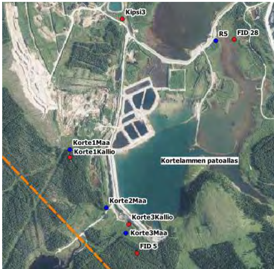
Kuva 3-7. Kortelammen ympäristön pohjaveden tarkkailupisteet.
