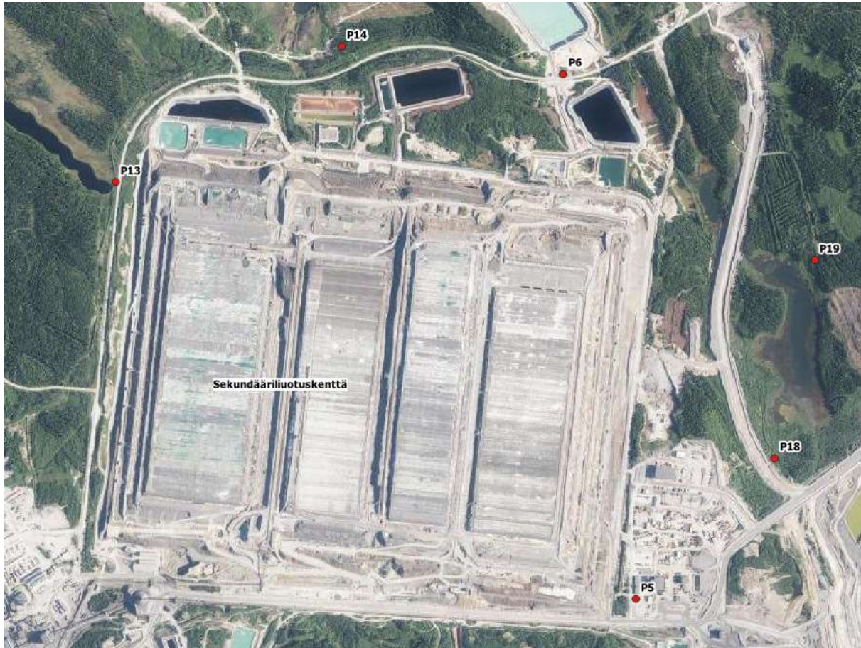
Kuva 3-9. Sekundäärii luotuskeskettä ympäristön pohjaveden tarkkailupisteet.
