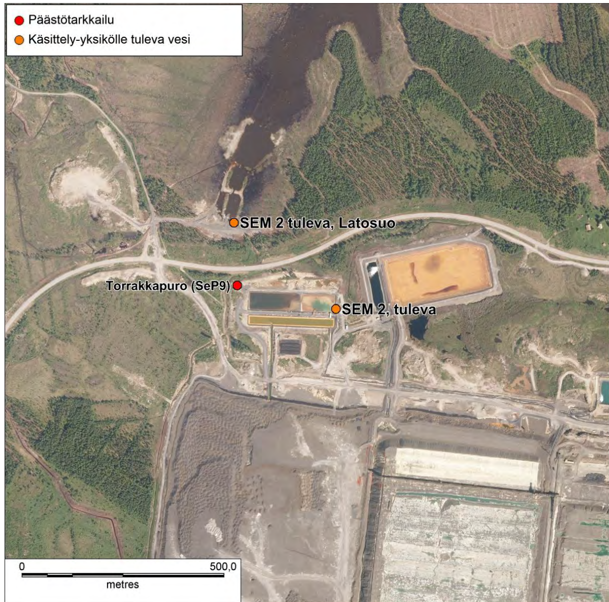
Kuva 2-5. Sekundääriliuotusalueen suojaumpausvesien käsittely-yksikön veden laadun tarkkailupisteet. Käsittely-yksikölle tulevat vedet (SEM2 tuleva, SEM2 tuleva Latosuo) ja lähtevät vedet (Torrakkopuro SeP9)
